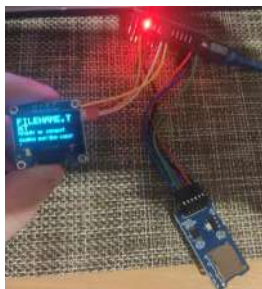
Рис. 2 Зчитування txt файлу мікропроцесорним пристроєм з карти пам'яті
