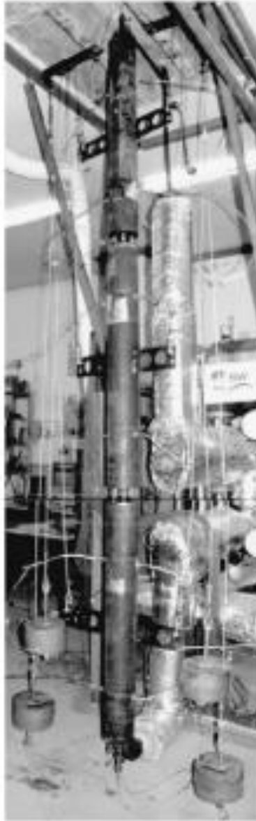
Рис. 5.1. Фото експериментальної установки для дослідження процесів тепломасообміну в елементі фазоперехідного теплоаккумулятора типу “труба в трубі”[28]
