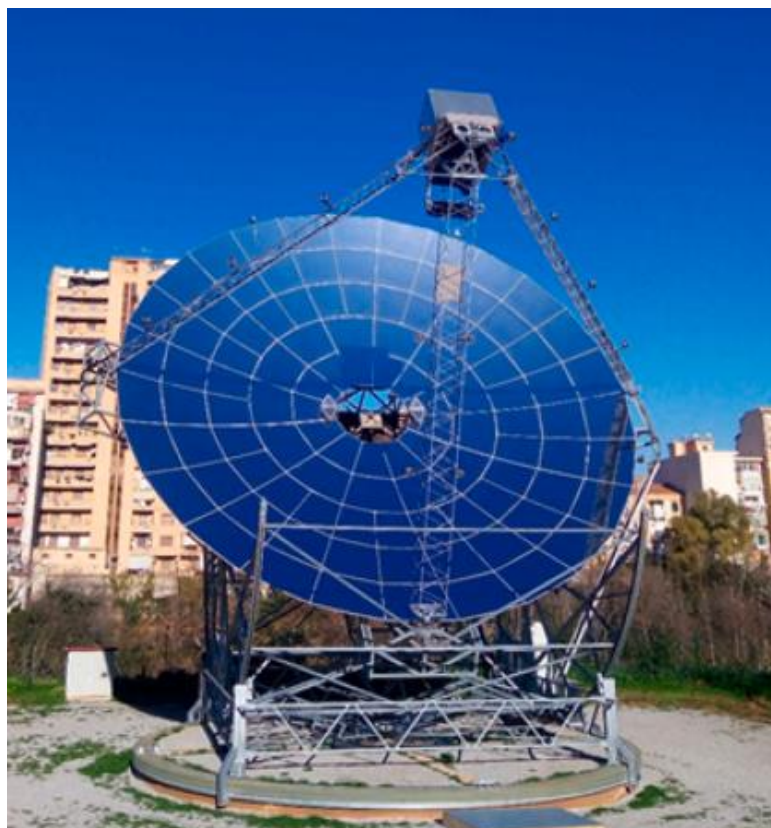
Рис.1.5. Параболоїдний концентратор із двигуном Стірлінга в Університеті Палермо (Італія) [34]
