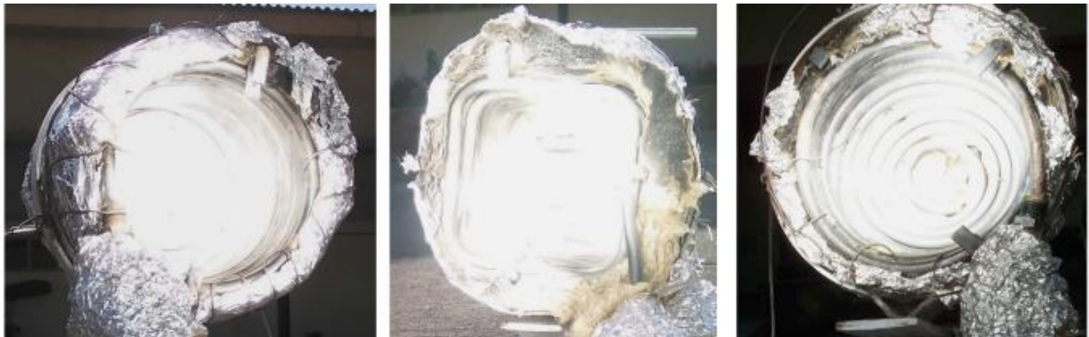
Рис.1.7. Ізольований циліндричний, кубічний, півсферичним теплоприймач для сонячної енергетичної системи із параболоїдним концентратором [40]
