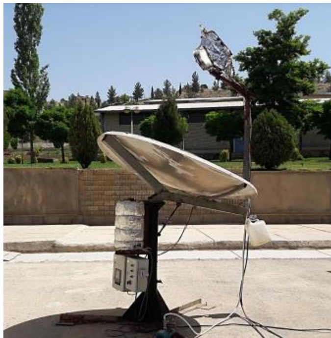
Рис. 1.8. Система для опріснення води з параболоїдним концентратором [42]
