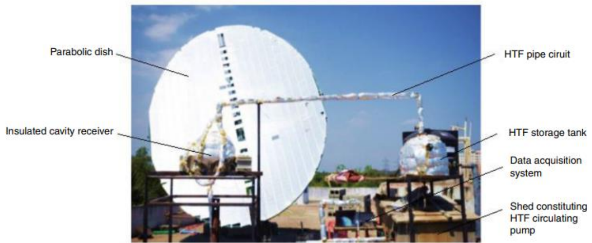
Рис. 1.10. Загальна схема сонячної енергетичної системи із параболоїдним концентратором [45]
