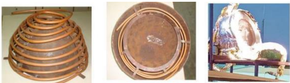
Рис. 1.9. Теплоприймач-теплоакумулятор сонячної енергетичної системи із параболоїдним концентратором [45]
