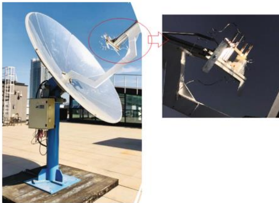
Рис.1.11. Дослідницький параболоїдний концентратор Енергетичного центру м. Туріна (Італія) [61]
